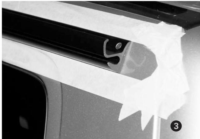
Par-devant placer le **spoiler avant** de la façon suivante : le fixer dans le prolongement du profilé alu et **si possible droit** – ne pas arquer d'un côté ! – et le **courber légèrement vers le bas sur le tracé du montant du parebrise**. L'amener jusqu'à la **lisière de finition du parebrise** afin que l'eau de pluie s'écoule par dedans.
