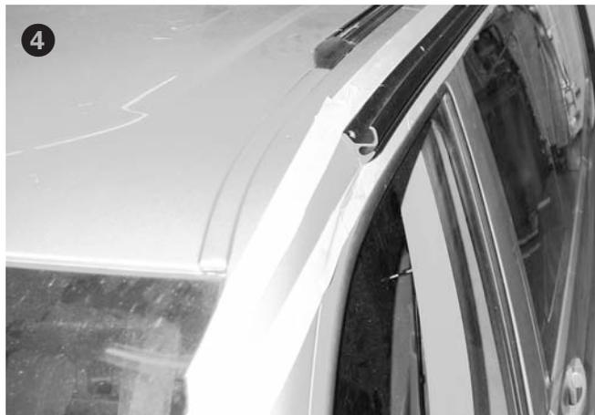
Appliquer pareillement du ruban de protection au-dessus et au-dessous du spoiler avant (cf. illustrations 4, 5).
