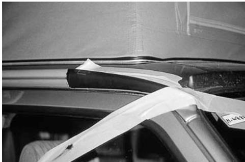
Fixer le spoiler avant à l'avant avec du scotch de marouflage : coller le scotch d'abord sur le pare-brise, puis sur l'extrémité du spoiler et enfin à la fenêtre conducteur/passager afin que le spoiler avant soit bien en place, et que sa pointe soit bien maintenue.
