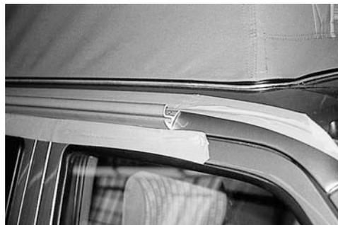
Avec du papier de verre, rendre légèrement rugueuse la surface sur laquelle va prendre appui le profilé alu TOP-RAIL. Ce faisant, il est impératif de contrôler l'état régulier du revêtement anodisé des surfaces de pose. En cas de fentes ou de parties irrégulières, poncer pour mettre l'aluminium à nu.
