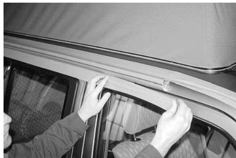
Il faut également mettre du scotch de marouflage au-dessus et au-dessous du spoiler avant.
