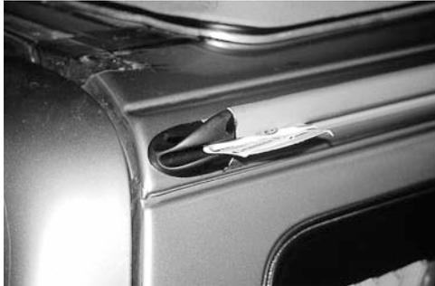
Surtout prendre garde à ce que des reliquats de colle ne gênent pas l'introduction d'un bourrelet dans la pièce de finition arrière, et à ce que le rail pour bourrelet du profilé alu ne gonde pas dans cette pièce de finition arrière : introduire un morceau de carton plié à la bonne épaisseur dans le rail pour bourrelet, une moitié dans le profilé alu et l'autre moitié dans la pièce de finition arrière, afin d'écarter à la bonne dimension l'orifice d'entrée du bourrelet.
