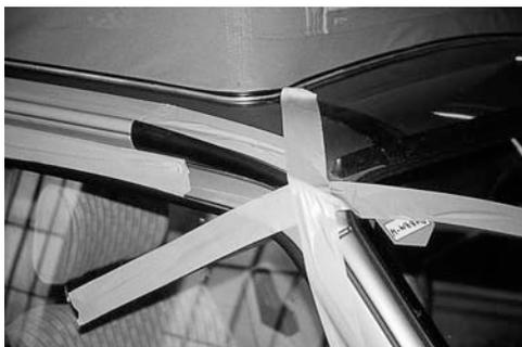
**⚠ ATTENTION** lors de chaque fixation avec du scotch de marouflage : ne jamais suivre le contour de la pièce de finition arrière ou du spoiler avant, mais toujours le coller seulement sur l'arête supérieure et largement sur la carrosserie pour obtenir la meilleure tension de fixation.
