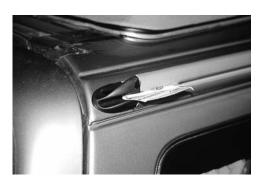
Vor allem ist auch darauf zu achten, daß beim hinteren Endteil der Kedereinzug nicht durch Kleberrückstände beeinträchtigt wird und, dass die Kederschiene des Aluprofils sich ohne Schwellen im Endteil fortsetzt: Hierfür kann ein Stück Karton, in passender Stärke gefaltet, in die Kederschiene so eingesetzt werden, dass eine Hälfte im Aluprofil und die andere Hälfte im Endteil steckt und den Kedereinzug entsprechend spreizt.
