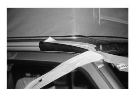
Der Frontspoiler wird vorn mit einem Abdeckband fixiert: Das Abdeckband wird zuerst an die Windschutzscheibe, dann über das Ende des Spoilers und anschließend an die Fahrer-/Beifahrerfenster geklebt, so daß der Frontspoiler richtig sitzt und die Spitze gut angedrückt wird.
