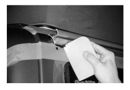
Die Enden des Aluprofils (an der Verbindungsstelle mit dem Endteil und Frontspoiler) werden außenseitlich mit Abdeckband beklebt, um hervorquellenden Kleber vom Aluprofil leichter entfernen zu können.
