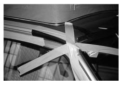
⚠ ACHTUNG bei jeder Fixierung mit Abdeckband: Nie die Form des Endteils oder Frontspoilers verfolgen, sondern stets nur an der Oberkante aufliegen lassen und großflächig an der Karosserie ankleben. Dadurch erhalten Sie die beste Fixier-Spannung.
