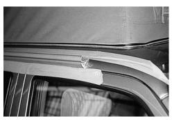
Die Auflagefläche des TOP-RAIL-Aluprofils wird mit Sandpapier leicht angerauht. Kontrollieren Sie unbedingt dabei den ordnungsgemäßen Zustand der Auflageflächen-Eloxierung. Sollte die Eloxierung Risse oder unregelmäßige Stellen aufweisen, müssen Sie an solchen Stellen bis auf das blanke Aluminium schleifen.
