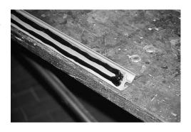
hervortritt, reicht die Strangdicke sicher aus, weil die Montage-Oberfläche am Fahrzeug gewölbt ist, so dass hier weniger Kleber ausreicht.
