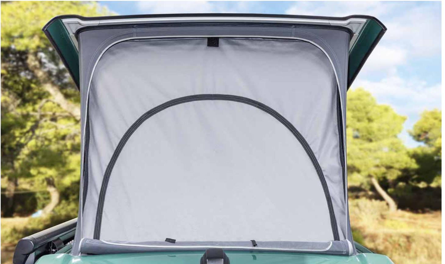
La parte delantera y la FLYOUT del ISO-TOP MK VI se deben quitar cuando se cierra el techo levantado. Made in Germany.
