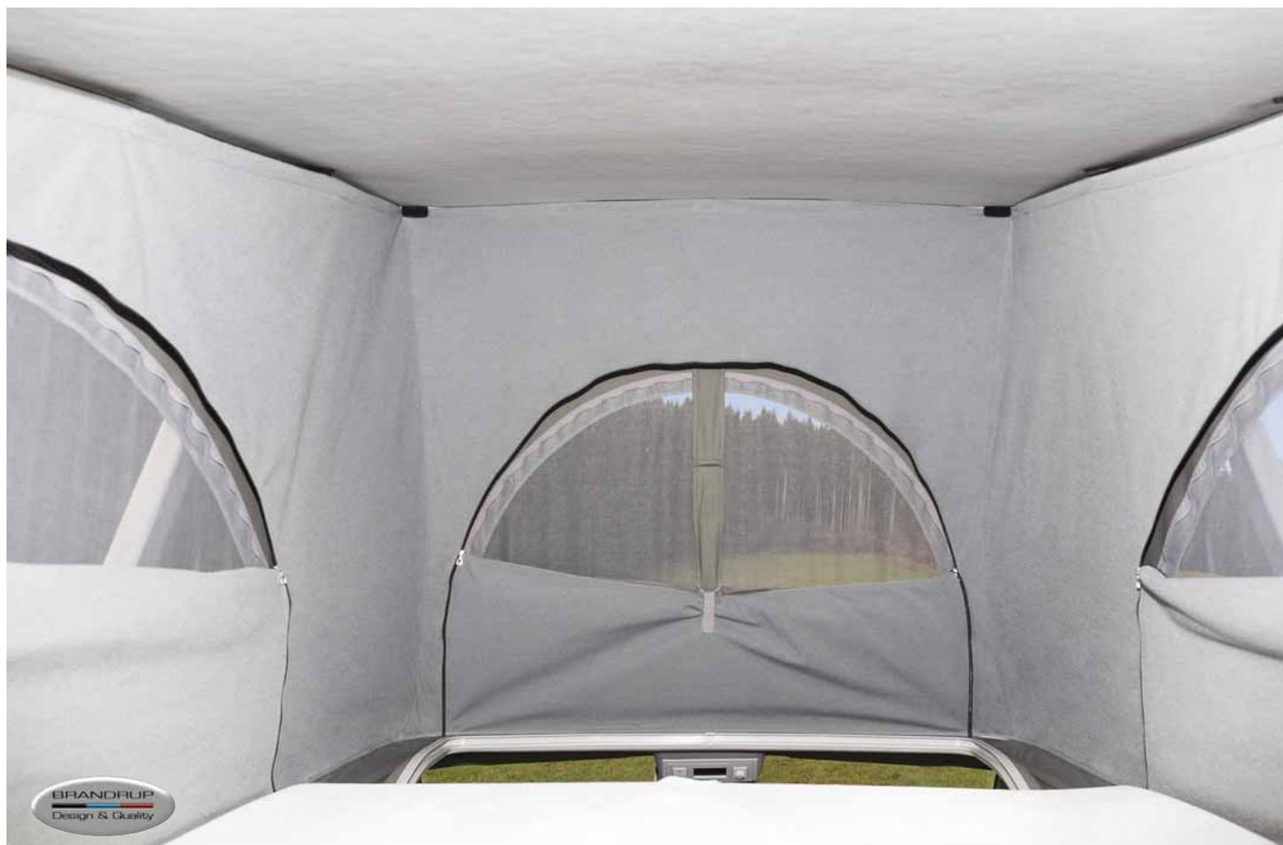
Por tres costados hay grandes ventanas con cierre de cremallera. Cuando hay una ventana de medio arco en el fuelle del techo, ISO-TOP se puede fijar al puntal del medio.
