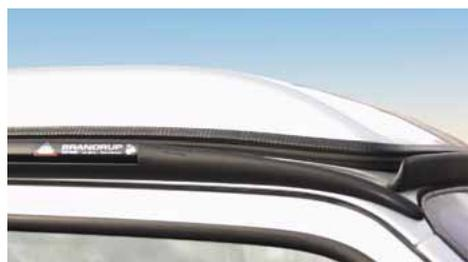
El spoiler delantero no sólo evacúa perfectamente bien el agua de lluvia, sino que reduce el ruido del viento en el techo elevado: Al conducir, se amortiguan los ruidos.
