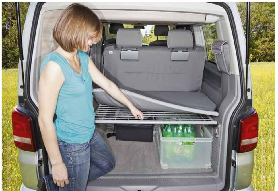
Para plegar la extensión de la cama al cargar la parte inferior del maletero, el iXTEND PAD se puede alzar atrás, sin tener que zafar las fijaciones: iXTEND PAD se queda perfectamente en su sitio, no se desliza. Abajo hay sitio para guardar, sin problema, botellas de 1,5 litros. Y pueden permanecer ahí, cuando la extensión de cama se baja para ser usada como cama para dormir.
