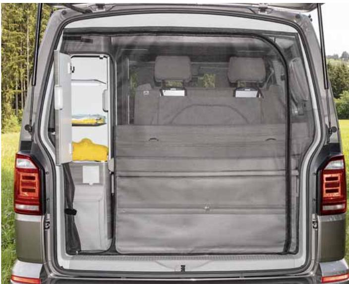
La nueva red FLYOUT para la apertura del portón trasero ofrece un acceso rápido a los compartimentos del armario maletero.
