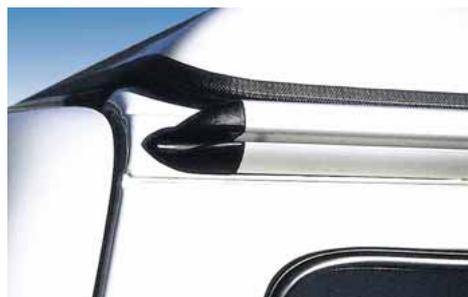
El cierre del maletero subraya el trazado de línea harmónico y evacua el agua de lluvia por los lados. El agua no corre dentro del portón al abrirlo.
