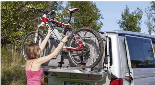
Se pueden llevar hasta dos bicicletas en el FLEXBAG Cargo – dentro del margen de carga de 60kg que ofrece el portaequipaje del maletero VW.
