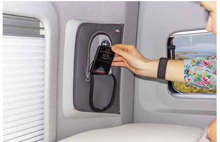
4TOP es el elemento final práctico para los nichos abiertos de depósito, de las columnas D. Su fijación se hace, todo alrededor, con un cierre autoadhesivo especial.
