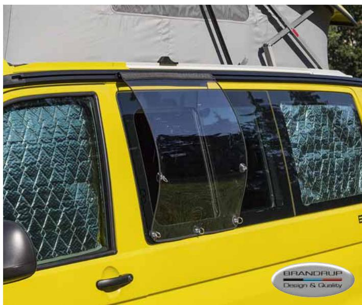
AIRSCREEN VW T6.1/T6/T5 está hecho en lámina de policarbonato („Makrolon®“) de muy alta calidad.
